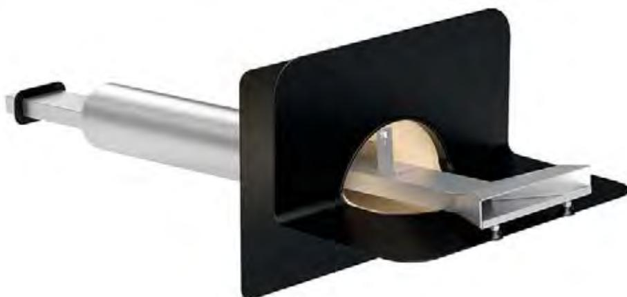
SitaVasant Double – zwei „Gullys“ in einem: Steigt der Wasserspiegel auf dem Dach über 35 mm, speit die autonome Notentwässerung des SitaVasant Double auf eine frei überflutbare Fläche
